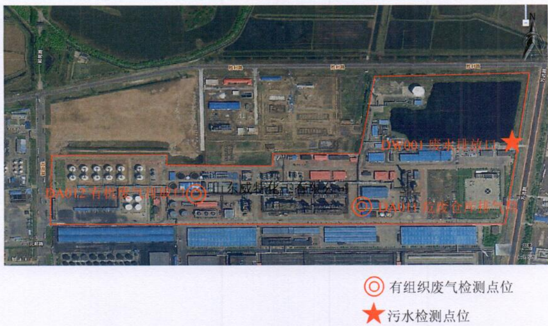
图 1 有组织废气、污水检测布点示意图
