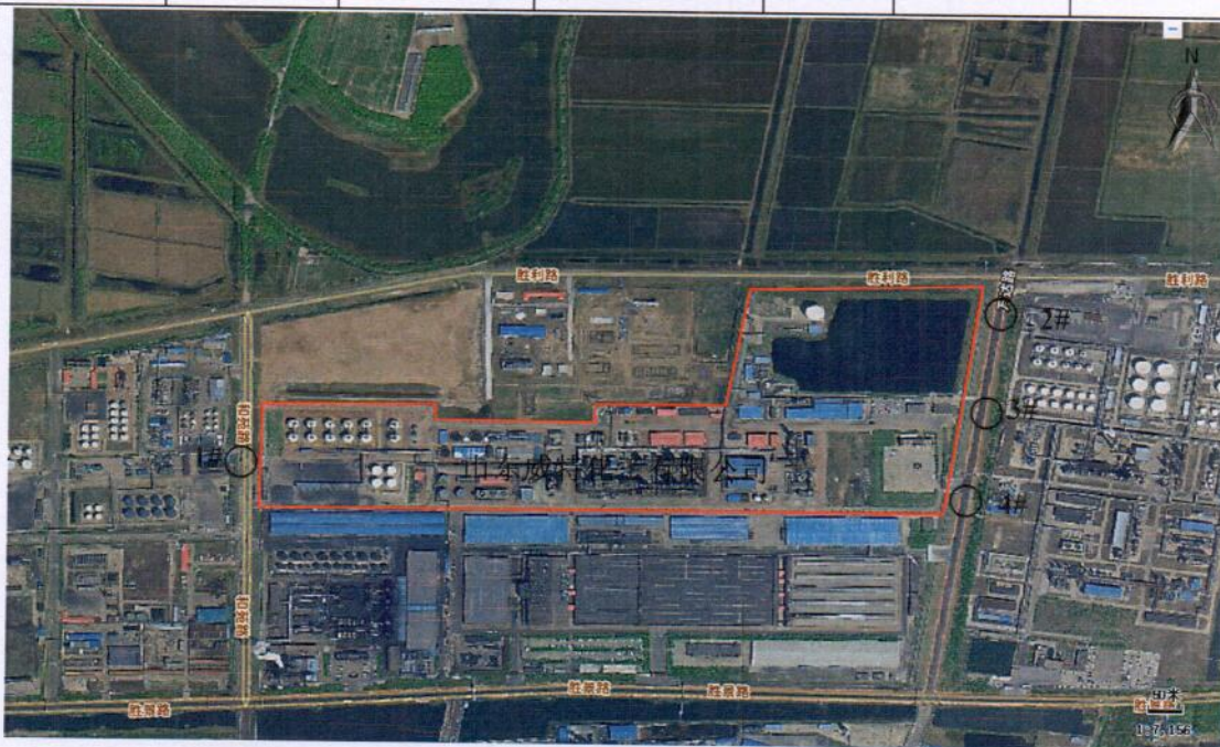
图 2 无组织废气检测布点示意图
